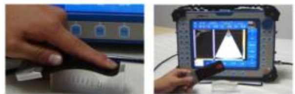
复杂曲面工件检测（柔性相控阵探头）
