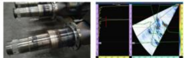
车桥电子束焊缝检测 ( AutoCAD图形加载 )
